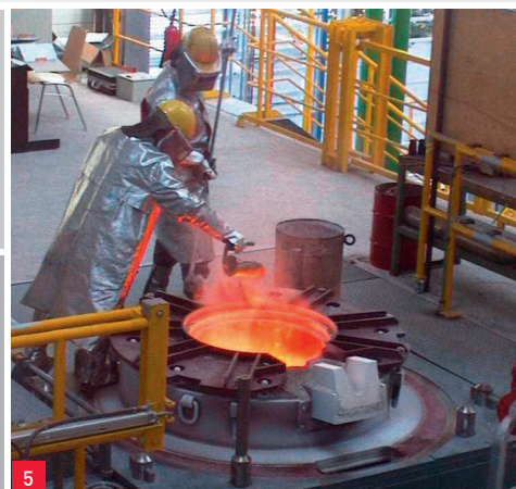
Разливка VID-Оху Обезуглероживание с обработкой растворенным кислородом и шлаком [5]
