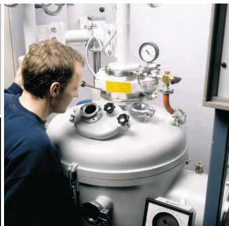
Наблюдение за вакуумным индукционным плавлением и литьем через смотровое стекло
