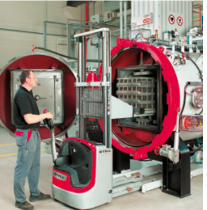
▲ Установки MonoTherm® различной конструкции для гибкой термообработки и цементации
