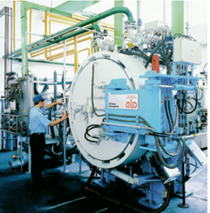
▲ Установка типа VKPgr для спекания деталей из твердого сплава при давлении до 100 бар
