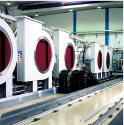
▲ Термический комплекс ModulTherm® для гибкой массовой термообработки и цементации деталей из широкого диапазона сталей
