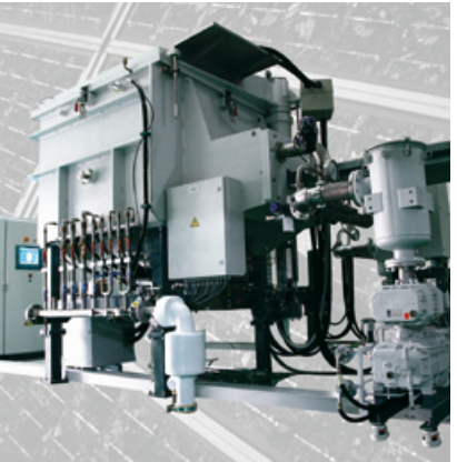
▲ Установка SCU 400 / 800 для плавки и кристаллизации кремния для солнечных батарей
