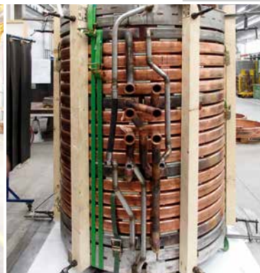
Eine Induktionsspule vor und nach der Aufbereitung
