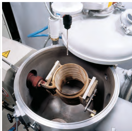
Измерение температуры с помощью термомпары с многоразовой защитной трубкой
