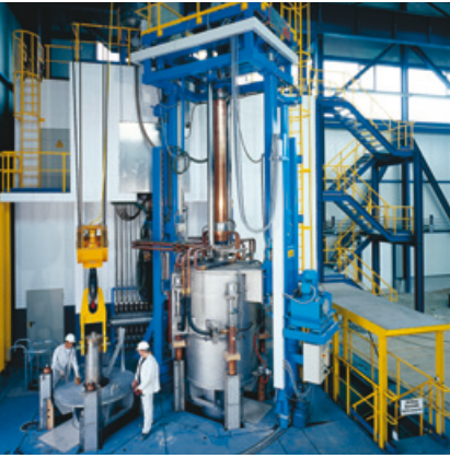
▲ 20-тонная установка ESR с возможностью плавки в защитном газе
